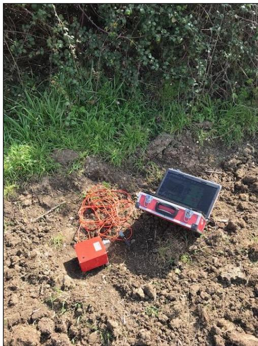
**FOTO 13 e 14** – Prova Hvsr 3 e Hvsr 4, eseguite tramite Geobox della Sara Instruments
