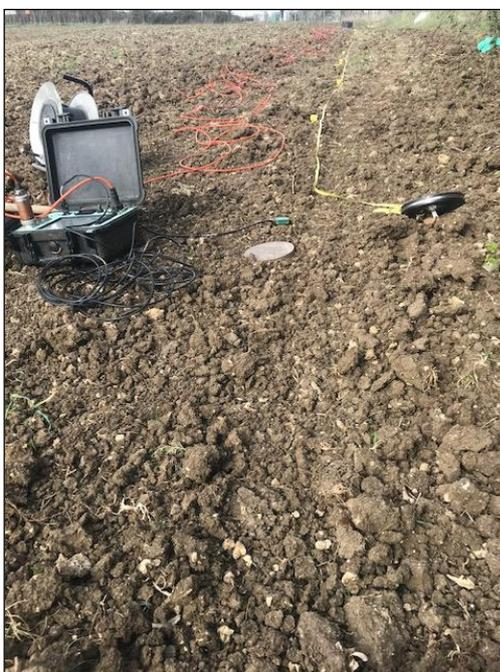
**FOTO 7 e 8** – Stesa sismica masw n. 1 e masw n. 2.
