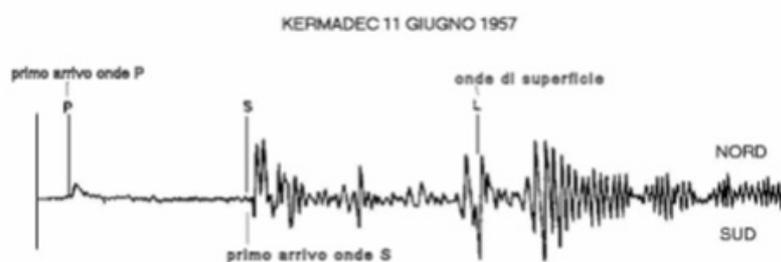
**Figura 4.** Sismogramma tipo registrato in superficie a grande distanza.
