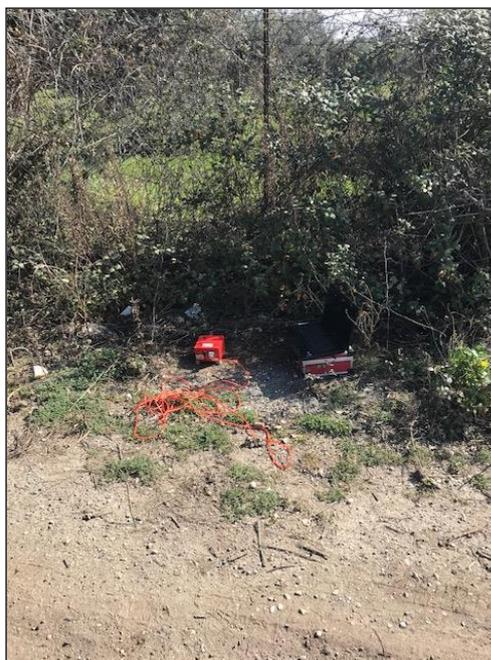
**FOTO 11 e 12** – Prova Hvsr 1 e Hvsr2, eseguite tramite Geobox della Sara Instruments
