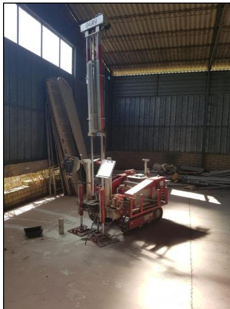
FOTO 3 e 4 – Rispettivamente postazione prova penetrometrica DPSH n.3 e n.4
