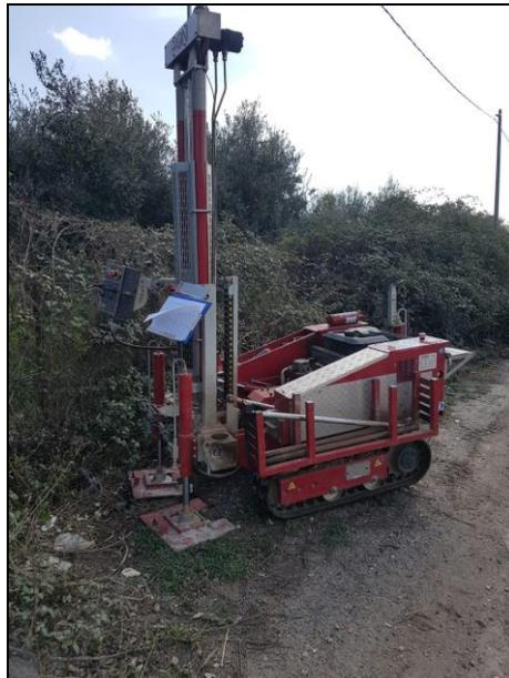
FOTO 1 e 2 – Rispettivamente postazione prova penetrometrica DPSH n.1 e n.2
