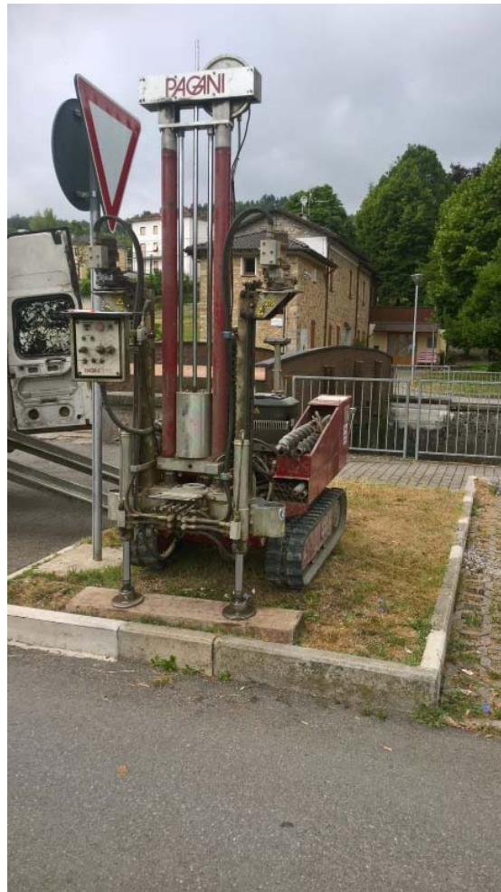
Figura B. 1 - Indagine penetrometrica DPSH1.
