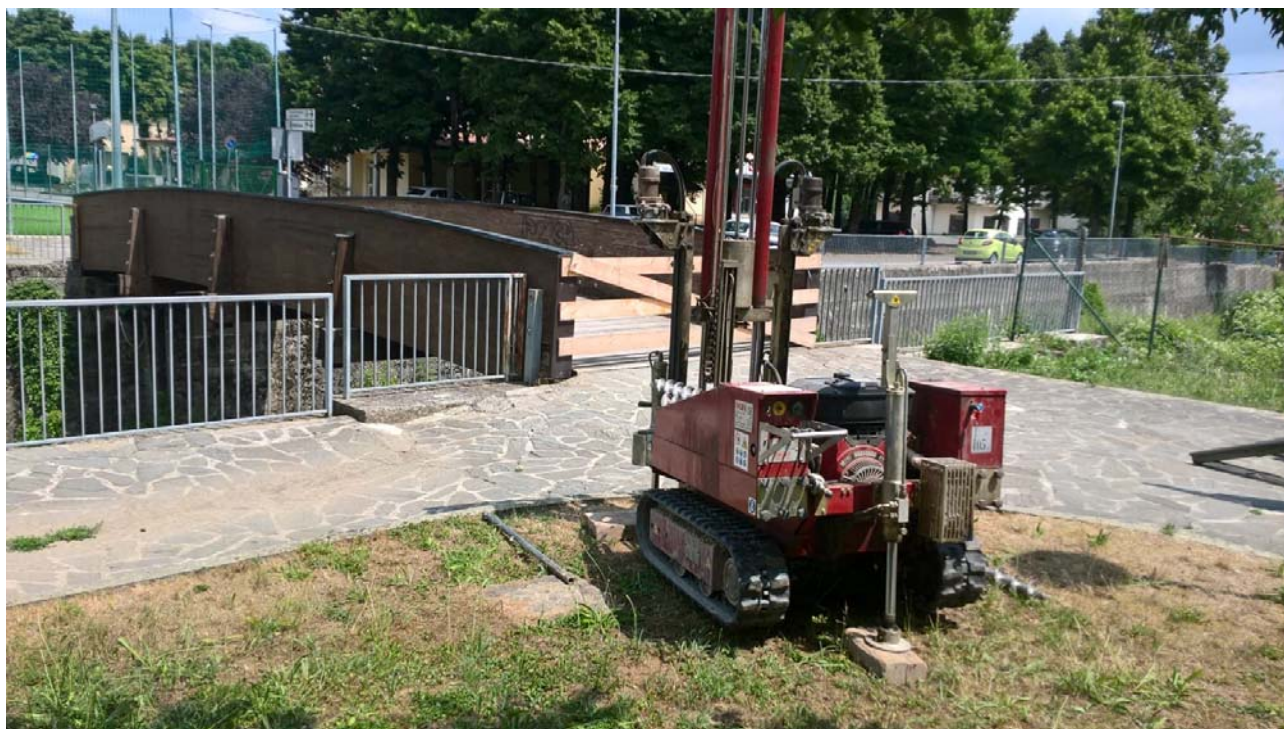
Figura B. 3 - Indagine Penetrometrica DPSH3.
