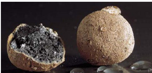
Argilla espansa - Dettaglio
