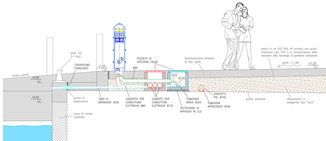
SEZIONE B-B: COLONNINA IDRANTE UNI 45 - Scala 1:25
