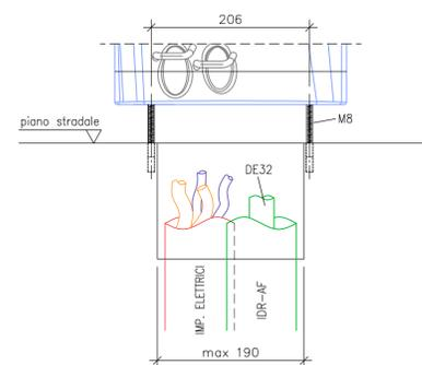
PARTICOLARE TERMINALE DI DISTRIBUZIONE CON SISTEMA CONTABILIZZATO DEI SERVIZI DI TIPO PREPAGATO
