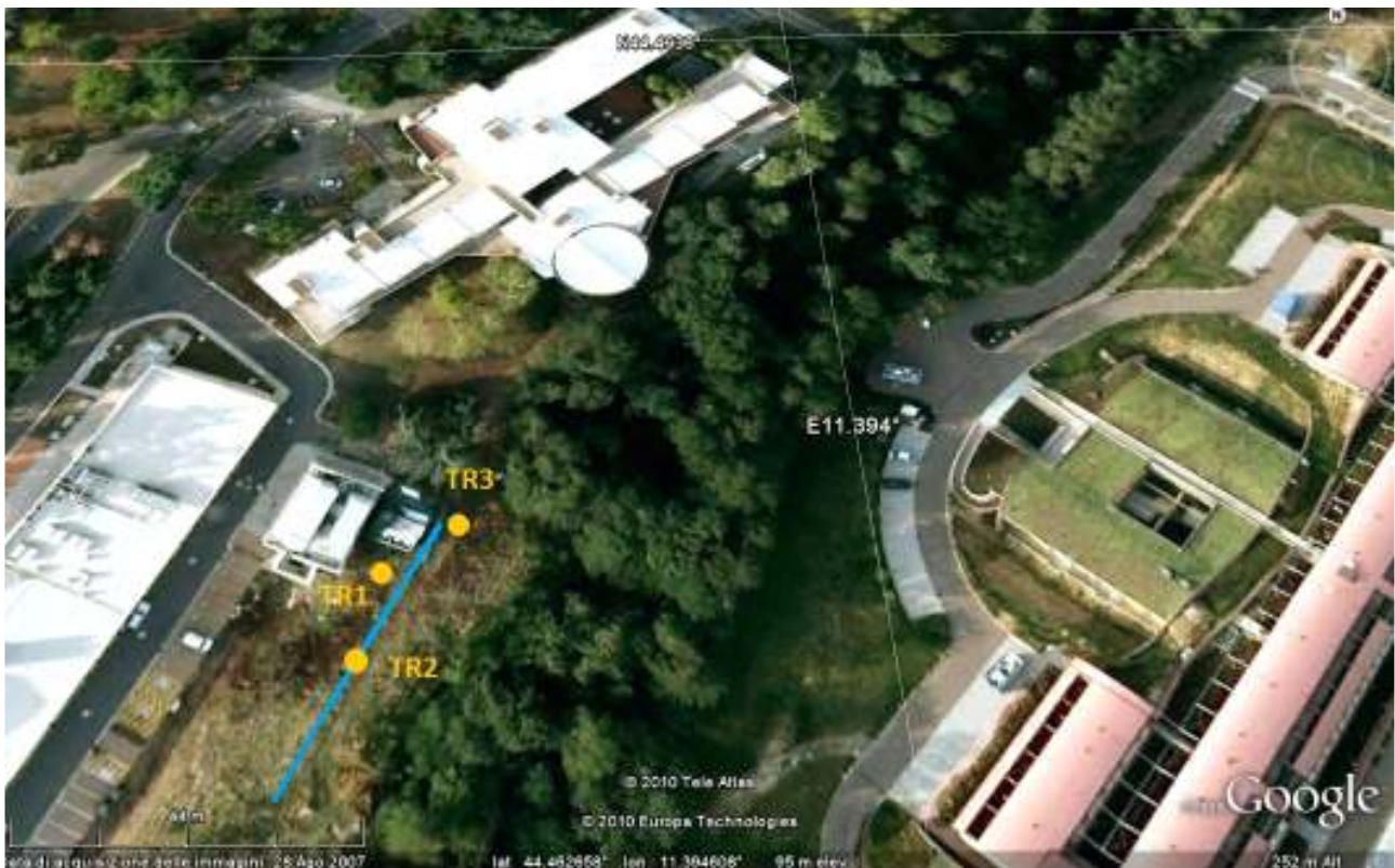
Figura 1. Ubicazione delle prove a stazione singola (cerchi gialli) e in array (linea azzurra). Foto da Google™.
