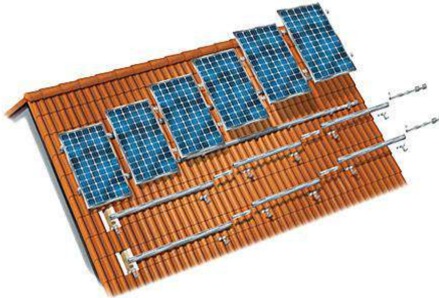
Figura 16 – Modalità di installazione (tetto a falda)
