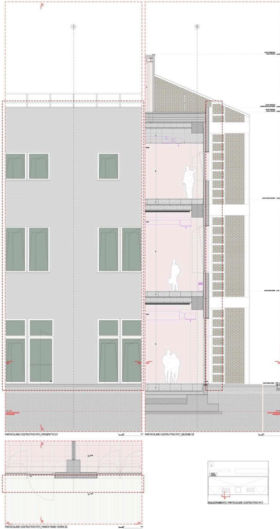
Progetto con inserimento della miglioria A.1 (sezione di dettaglio):
