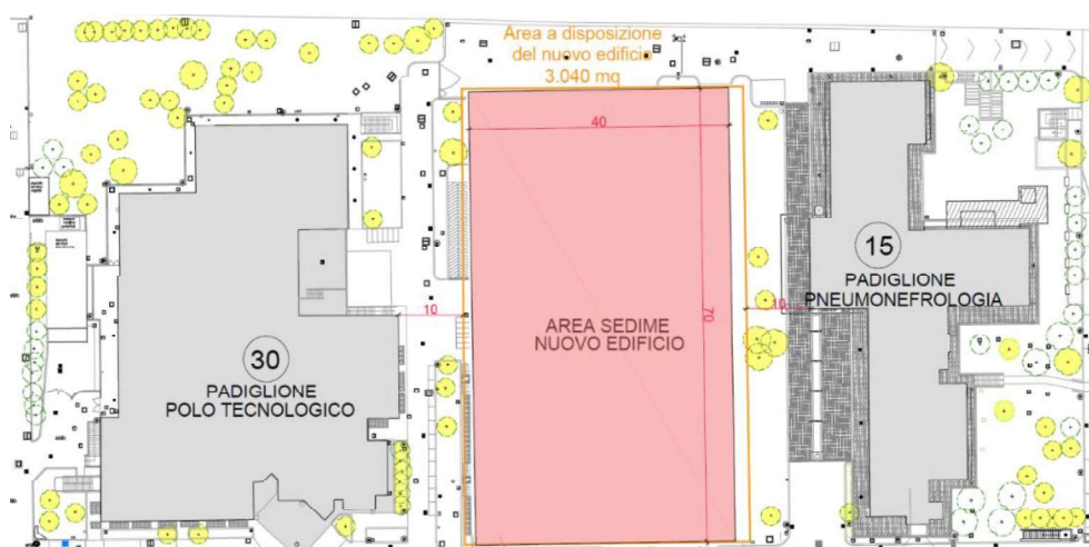
Figura 27: Area di sedime del nuovo edificio
