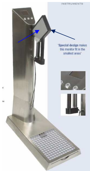
Figura 1. Contaminometro mani e piedi Veenstra. Le frecce riportate indicano il posizionamento delle mani sinistra (azzurra) e destra (blu) nella regione dedicata alla contaminazione delle mani.
