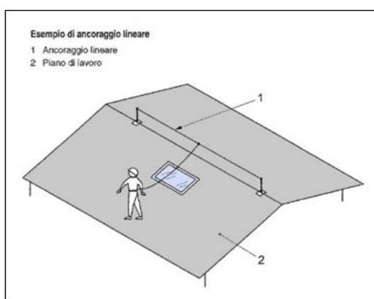
**Ancoraggio di estremità:** elemento iniziale o terminale di un dispositivo di ancoraggio lineare di tipo C oppure di tipo D che collega l'estremità di una linea di ancoraggio flessibile o di una linea di ancoraggio rigida alla struttura.
