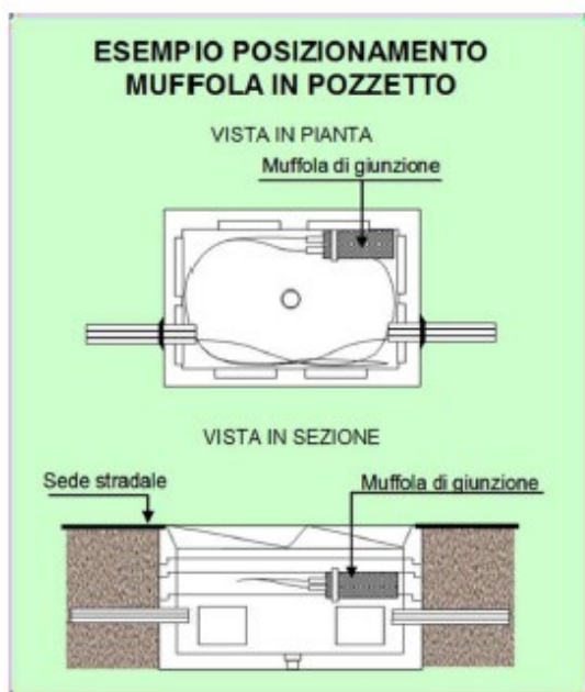
Esempio: Schema di posizionamento eventuale muffola nel pozzetto
